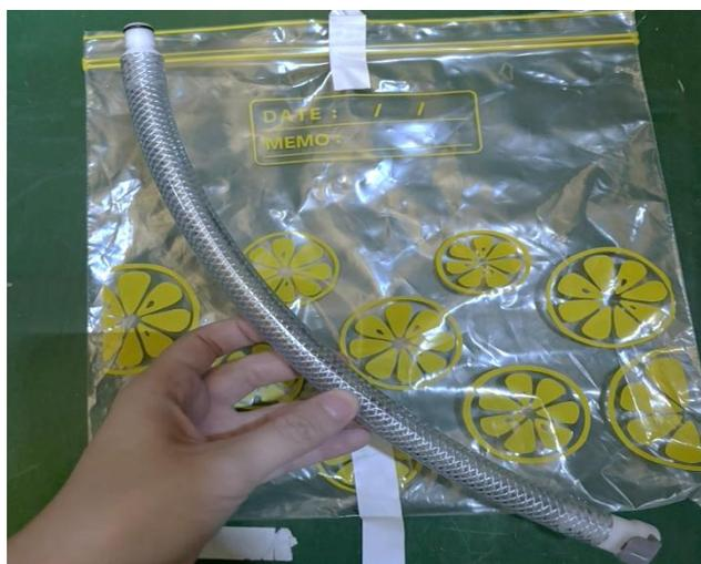
6. 排水管插入主機背後的排水孔，將水排出至方形鐵盒中。
